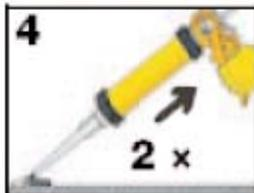
Per ogni cartuccia nuova, oppure dopo aver cambiato il miscelatore statico, i primi cordoncini (2 cordoncini) non possono essere utilizzati, fino a che non si consegue una consistenza uniforme di miscelazione.
