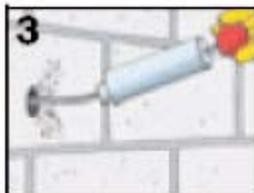
Dopo ogni passaggio di pulizia il foro deve essere pulito con aria compressa o pompa di soffiaggio. Importante: impiegare dispositivi ad aria compressa senza olio.
